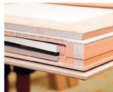
Schichtenweiser Aufbau der Türen
